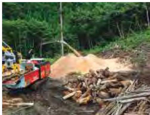
移動式チップパーによる林地残材のチップ生産
