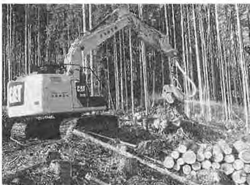
9月に導入したハーベスタ(ケトー150S)による造材の様子
